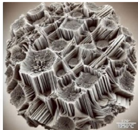
Immagine: grani cristallini ingrossati e le dislocazioni all'interno del reticolo dell'acciaio sottoposto ad alte temperature a Temp. 1250° C.
