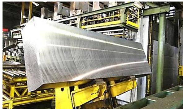
**Fig.37** - Bramma lega A0 dopo omogeneizzazione / *Slab of Alloy A0 after homogenization.*
