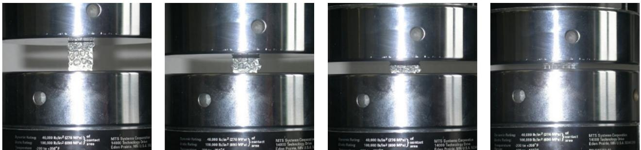
**Fig.7** - Successivi step di compressione di un provino in schiuma di Al / *Compression steps of an Al foam sample.*
