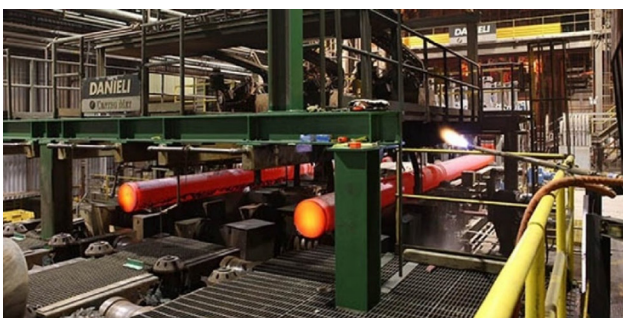
Fig.2 - a) laminatoio di ABS Sisak d.o.o.; b) schema del ciclo di produzione / a) rolling mill of di ABS Sisak d.o.o.; b) scheme of the production cycle.
