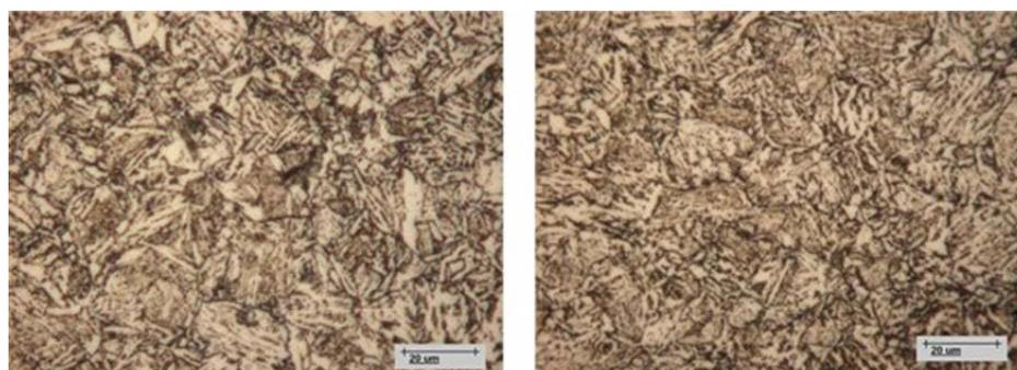
**Fig.5** - Caso 2: microstruttura dopo trattamento di tempra e rinvenimento (Q&T) della bussola. Sezione trasversale. Reagente: nital 2%. Microscopia ottica. / Case 2: microstructure after Q&T treatment of the sleeve. Transverse specimens. Etching: nital 2%. Light microscopy.
