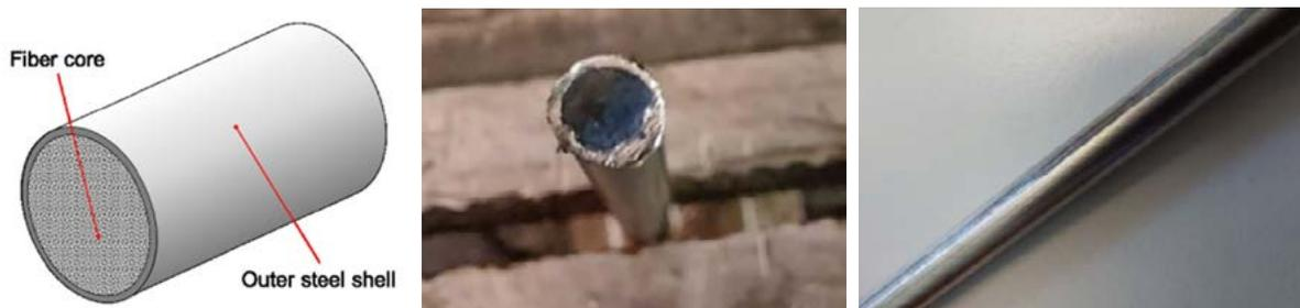
**Fig.1** - Concetto di filo ibrido (a sinistra) e campione realmente prodotto (a destra) / Design of the hybrid wire (left) and produced wire (right).
