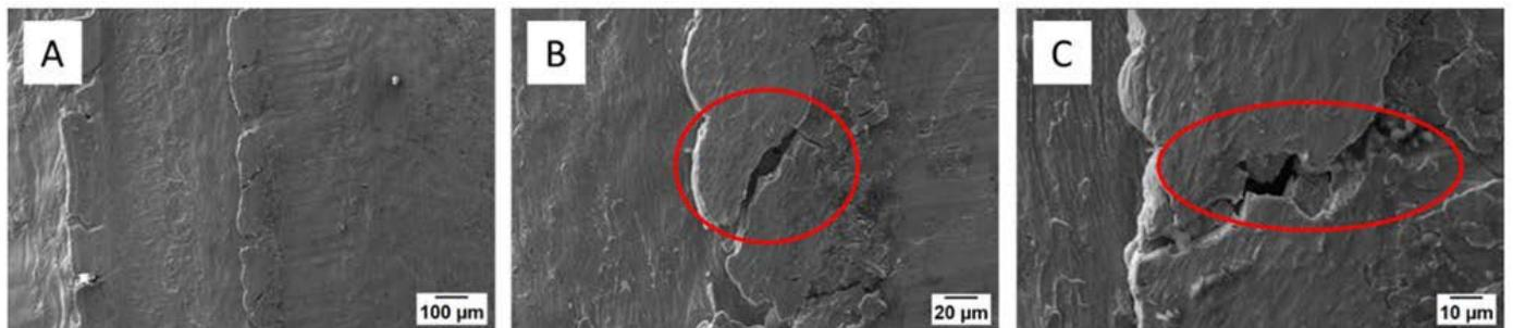
**Fig.8** - Risultati delle osservazioni al SEM dei campioni piegati dopo test di corrosione sotto sforzo (a) 200X; (b) 1000X; (c) 2000X / Results of the SEM observation of the stressed samples after SCC tests (a) 200X; (b) 1000X; (c) 2000X.
