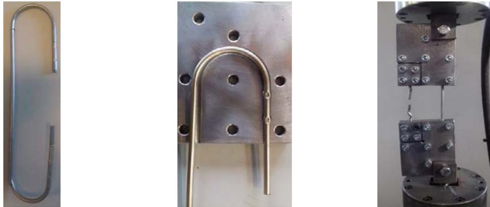
**Fig.2** - Geometria dei campioni utilizzati nella valutazione della resistenza meccanica e afferraggi sviluppati / Geometry of the samples and of the clamping systems employed for the mechanical characterization of the wires.
