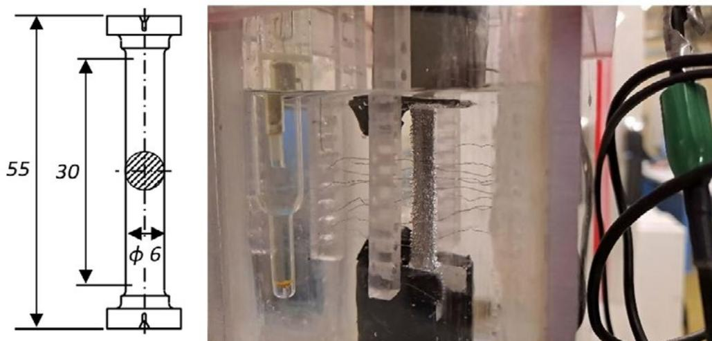
**Fig.2** - A sinistra: disegno di un provino SSRT (misure in mm); a destra: Cella elettrochimica con provino montato all'interno durante il caricamento galvanostatico. / Left: sketch of a SSRT specimen (measures in mm); right: electrochemical cell with specimen mounted on the inside during the galvanostatic charging.
