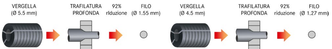
Fig.9 - Schemi di trafilatura profonda per vergella da 5.5 mm e 4.5 mm.
