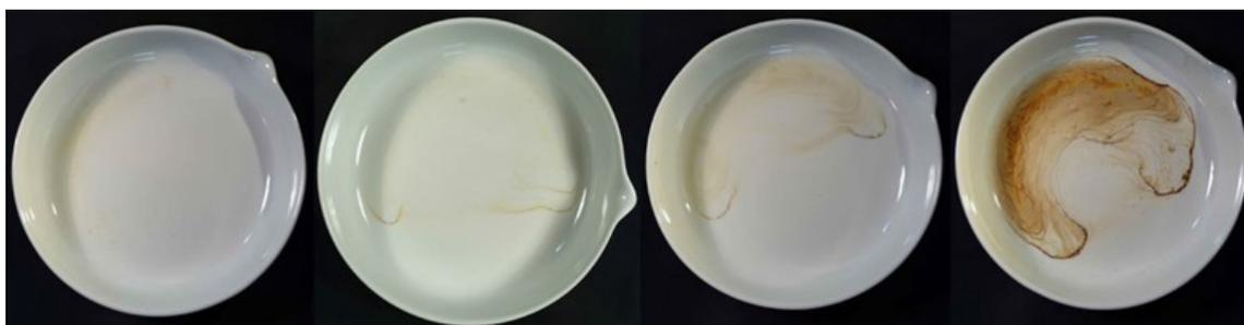
**Fig.5** - Confronto del residuo di diversi saggi a concentrazione di ossigeno crescente, da sinistra a destra senza saldatura, 50-150 ppm, 800-1000 ppm, senza protezione - comparison of the residues of the specimens at different oxygen level, from left to right no welding, 50-150 ppm, 800-1000 ppm, no protection
