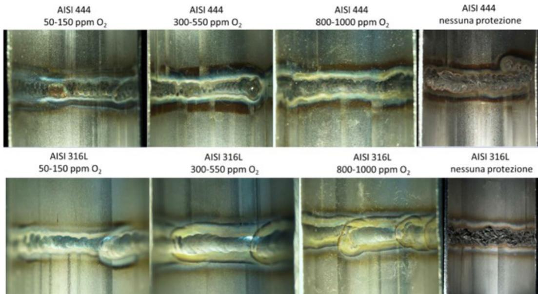
**Fig.2** - Esempio dell'ossidazione dal lato interno dei tubi dopo saldatura, sopra l'AISI 444 e sotto l'AISI 316L / oxidation of the internal side of the tubes, AISI 444 above and AISI 316L below.
