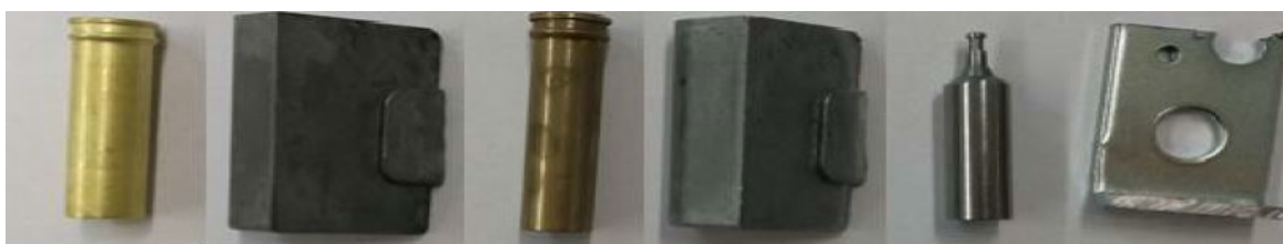
Fig.1 - Forma dei campioni per i test di corrosione / Shapes of the samples employed in the corrosion tests.
