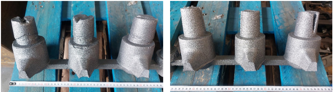
Fig.8 -Dettaglio degli alimentatori dopo granigliatura. In alto, i residui della classica manica 6/9. In basso, i residui della manica CHEMEX EK 50/80 T.
