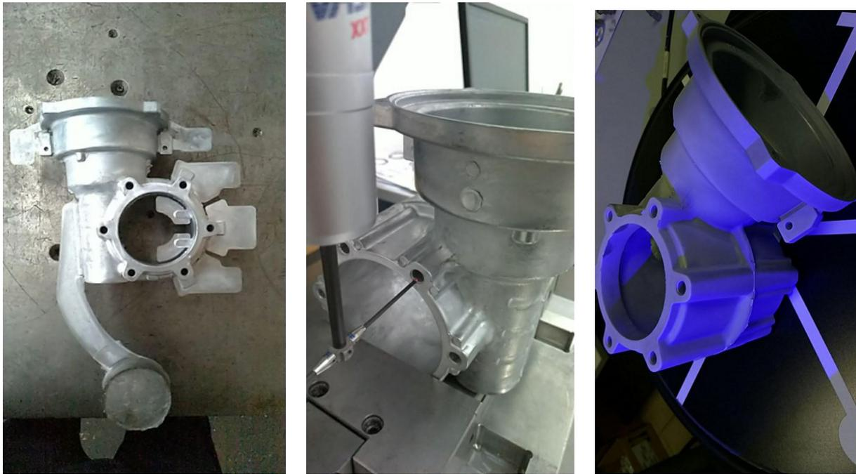
**Fig.9** - Stampata prodotta; controllo dimensionale CMM e Ottico.
