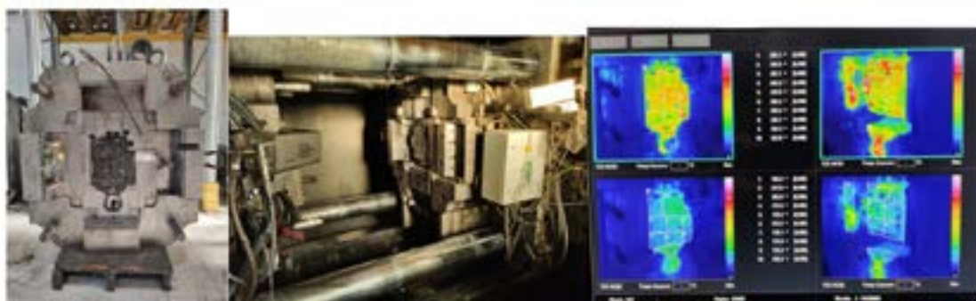
Fig.19 - Implementazione del sistema di monitoraggio nelle attrezzature.
