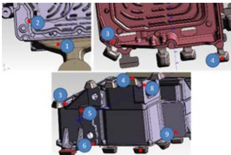
Fig.10 - Posizione delle termocoppie.
