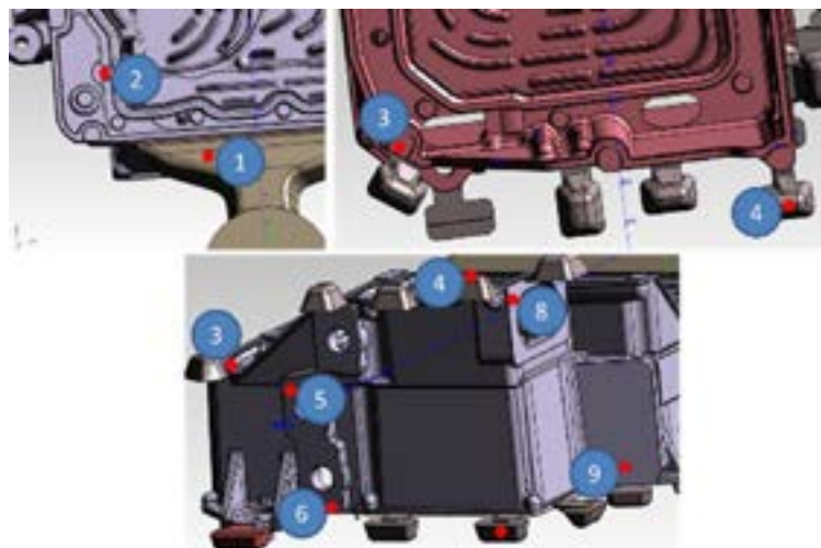
Fig.1 - Posizionamento delle termocoppie a contatto rispetto al getto.
