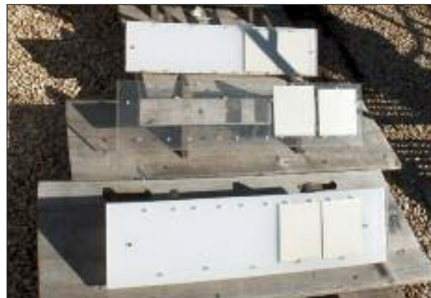
FIG. 1 Configurazione di esposizione dei campioni per l'invecchiamento naturale: inclinati di 45° e rivolti verso Sud.
