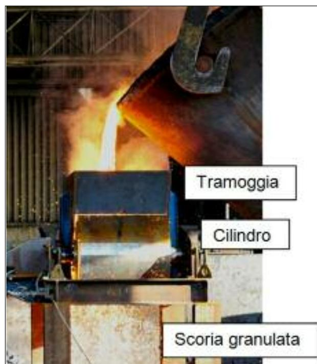
**FIG. 7** *Impianto prototipo per l'esecuzione di prove di granulazione a secco di scoria EAF.*
